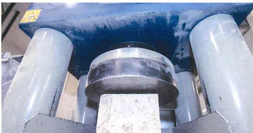
Nei laboratori del Dicatam. Prove di resistenza su conglomerati da scarti di edilizia // NICOLI FOTOREPORTER
