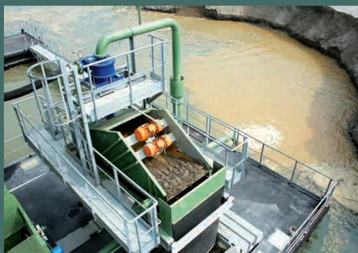
Il ciclone ha il compito di separare la sabbia fine dai fanghi e dai materiali in sospensione. La sabbia fine più pesante cade sul vaglio asciugatore posto sotto previsto unicamente al recupero della sabbia fine. La sabbia drenata viene quindi trasferita sul nastro di uscita.
