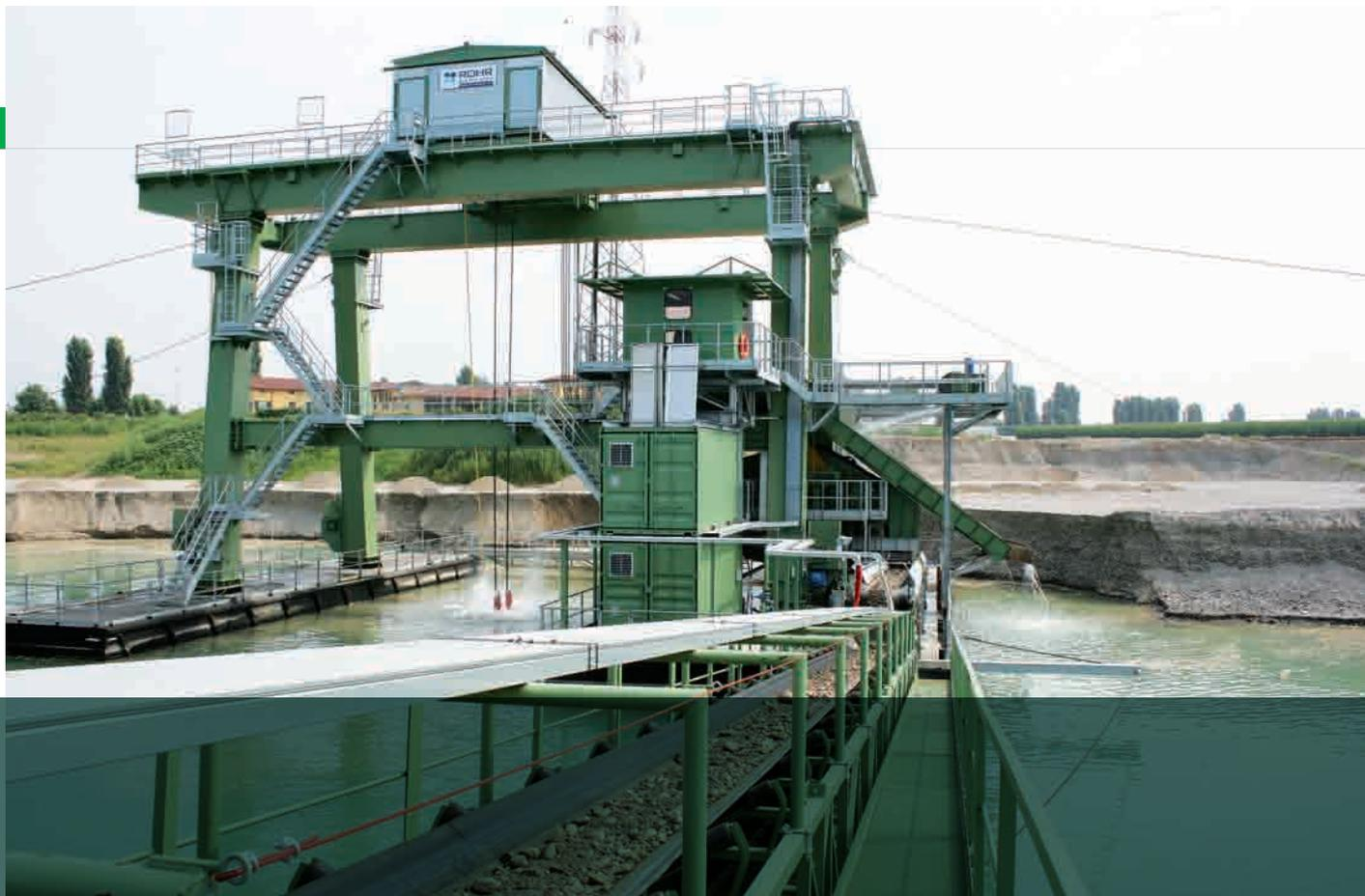
Un temporizzatore provvede all'apertura e chiusura della tramoggia. In tal modo l'angolo di apertura è variabile e può essere adeguato al tipo di materiale da trattare.
