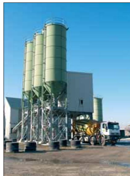
■ A Berlingo è installato un impianto Personal 6.30 Dual-DT capace di una produzione teorica a dosi secche di 100 m 3 /h e di 75 m 3 /h di premiscelato. Completamente automatizzato, l'impianto è dotato di un mescolatore a regime forzato Turbomix TM 3000/2000 N da 2 m 2 di calcestruzzo
